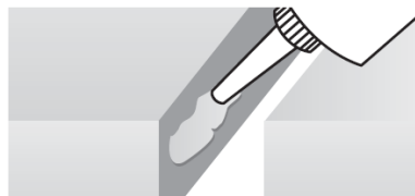
Nanášení spárovacího lepidla na přesně řezané hrany očištěné od prachu
